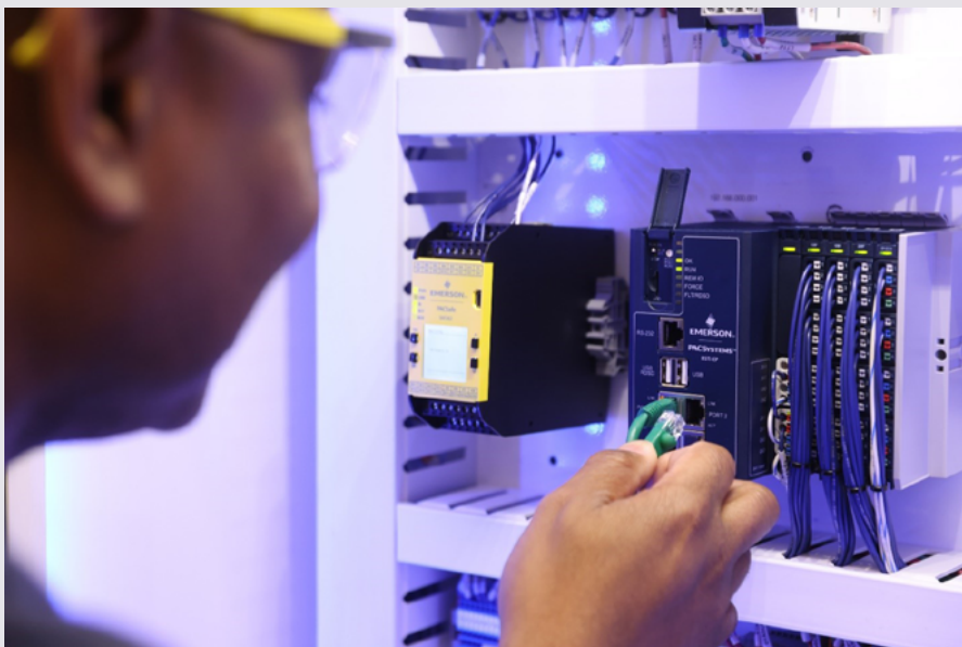
I controllori della serie CPE 200 offrono comunicazioni aperte tramite OPC UA Secure e altri protocolli industriali
